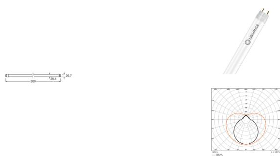
**Scheda tecnica Ledvance Tubo LED T8 EM Value Conventional (EM), Mains (AC) Standard Output 10W 1200lm - 865 Luce Del Giorno | 90cm - Sostitutiva 30W**
