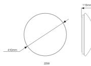
**Scheda tecnica Noxion Bulkhead LED Corido Bianca 22W 1839lm - 830 Luce Calda | 410mm - IP44**
