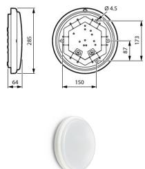
**Scheda tecnica Philips Bulkhead LED Ledinaire WL070V Bianca 20.9W 1700lm - 830 Luce Calda | 285mm - IP65 - Sensore di movimento e luce**
